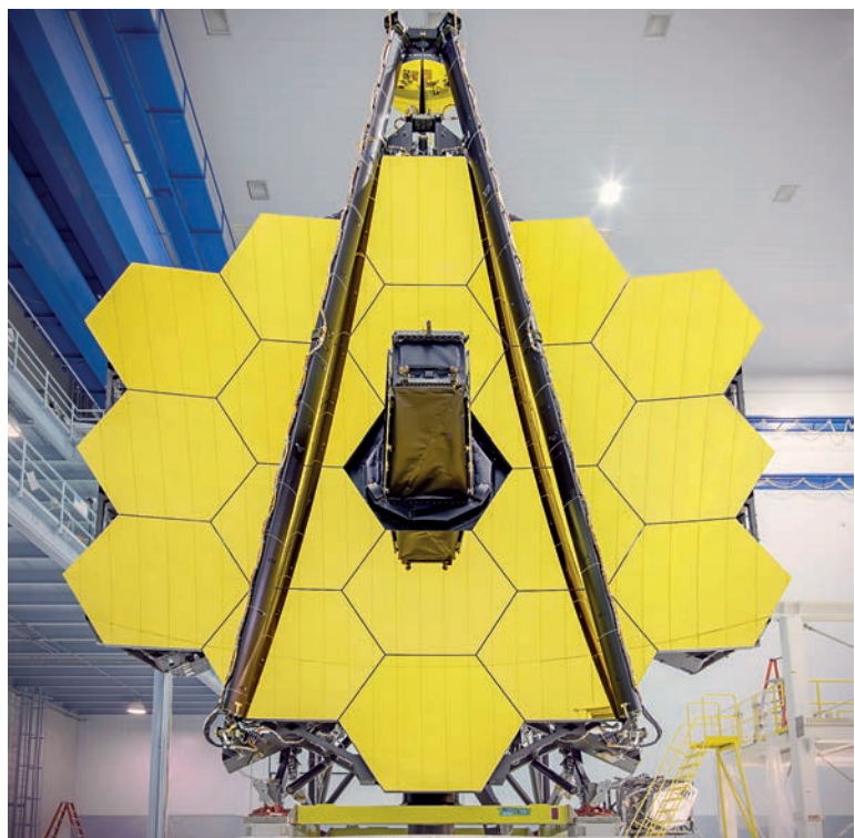
Lo specchio primario quando era ancora in fase di montaggio al Goddard Space Flight Center. Si può ammirare il mosaico di 18 tasselli di berillio, ricoperti d'oro, che compongono lo specchio consentendone il ripiegamento.
