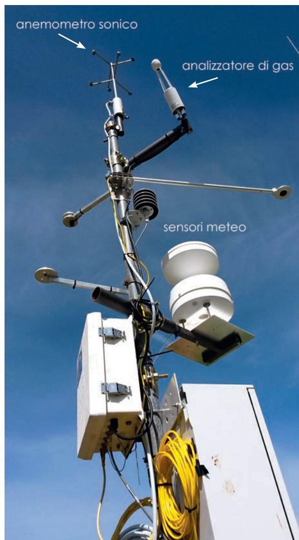
Sistema di Eddy Covariance costituito da anemometro sonico e analizzatore di gas a infrarossi con i sensori meteo ausiliari.
